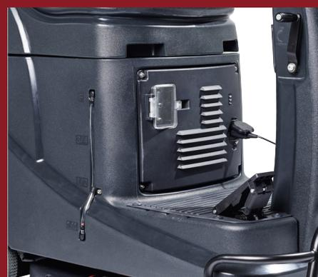
Cargador integrado que permite conectar la máquina fácilmente a la toma de corriente en cualquier enchufe
