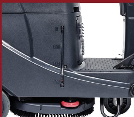
Indicador del nivel de solución con volumen visible en el depósito
